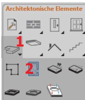
Ziehen Sie danach einen Rahmen über die bereits gezeichneten Wände. Der Rahmen wird über zwei Punkte (1,2) diagonal aufgezogen. Bestätigen Sie danach die ausgewählten Elemente mit der rechten Maustaste.
