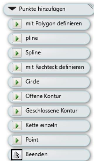
Die Punkte setzen Sie in unserem Beispiel ohne Bezug zum Koordinatenursprung - also beliebig. Positionieren Sie einen Punkt durch einen Klick mit der linken Maustaste, eine Dialog erscheint, in dem die Höhe des Punkts eingegeben wird.
