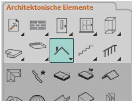
Die Kontur/Form des Daches wird dabei analog dem **Decke über Wandauswahl** Befehl erzeugt d.h. ziehen Sie einen Rahmen über das gesamte Dachgeschoss.
