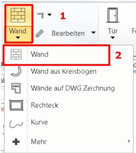
Geben Sie den Startpunkt der Wand an. Klicken Sie dazu mit der linken Maustaste an eine beliebige Stelle in das Grundrissfenster und bewegen Sie **die Maus ungefähr in die Richtung** in der Sie die Wand zeichnen wollen, in diesem Beispiel nach unten.
